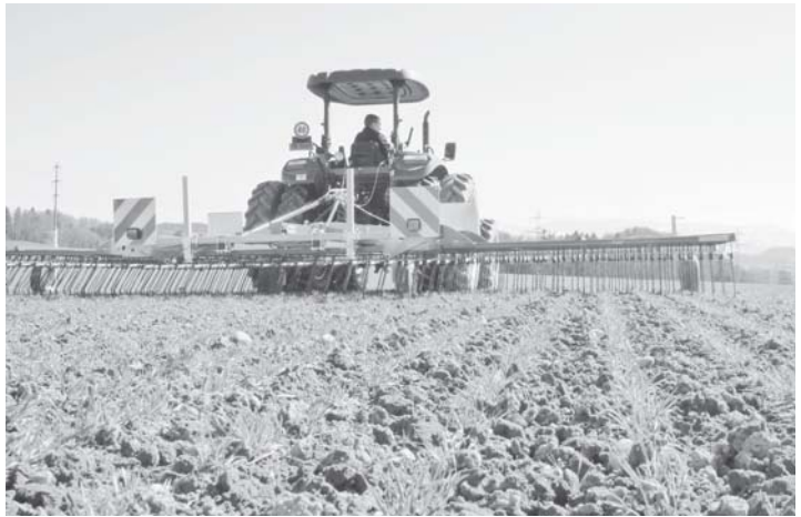
Ausgeklügelte Spezialmaschinen wie z.B. ein Präzisionsstriegel machen die Herbizidspritze überflüssig Foto © Treffler Maschinenbau
